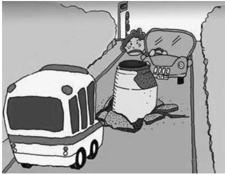
下水道管浮上の現象 出典：ハットリング工法協会
