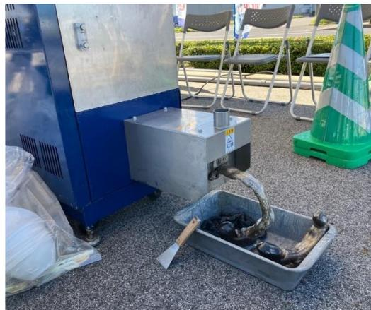
Sea 級グルメで使われたポリスチレン食器を会場内で再資源化(専用の機械に投入し原料化)
