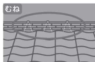
瓦にボルト・ビス等による緊結がない
