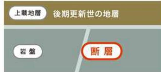
図の例では、上載地層にずれがないことから、断層は、後期更新世以降に活動していないと評価できる。
