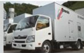
高圧発電機車
