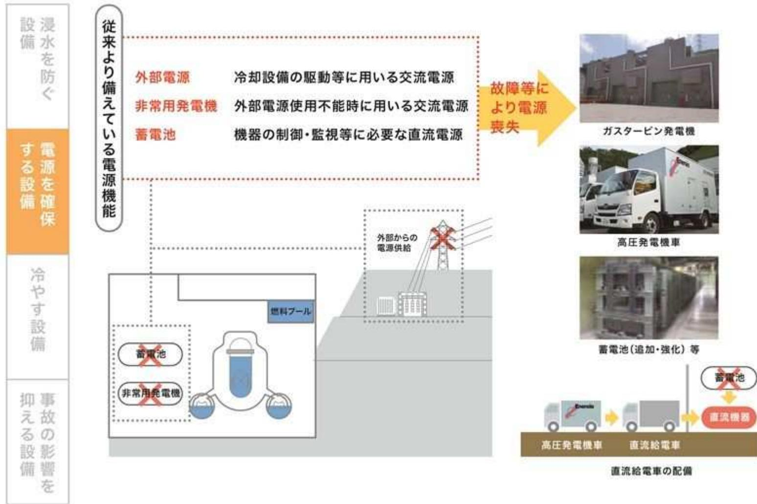
従来の電源機能(外部電源, 非常用発電機, 蓄電池)が喪失した場合に備え, ガスタービン発電機や高圧発電機車の配備, 蓄電池の追加, 直流給電車の配備を実施。
