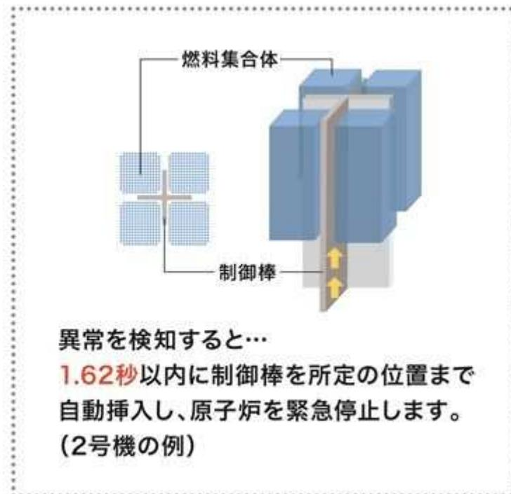
核分裂に必要な中性子を吸収する「制御棒」を挿入し、核分裂を止めて原子炉を停止。
