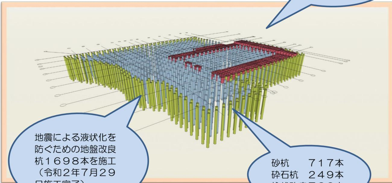
地震による液状化を防ぐための地盤改良杭1698本を施工（令和2年7月29日施工完了）
