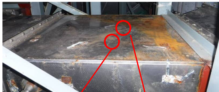
18個の腐食孔の一例
