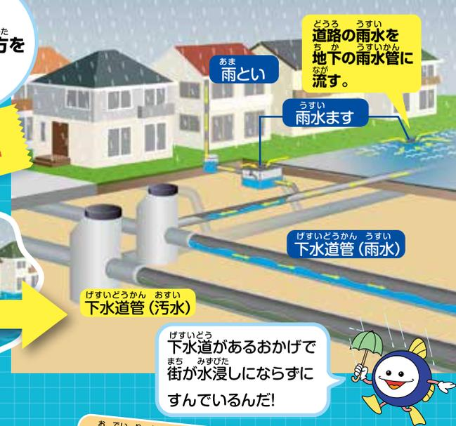
道路の雨水を地下の雨水管に流す。
